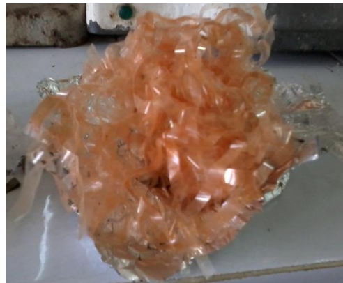
Hình 6. Dây băng đun với acetone trong 6 giờ
