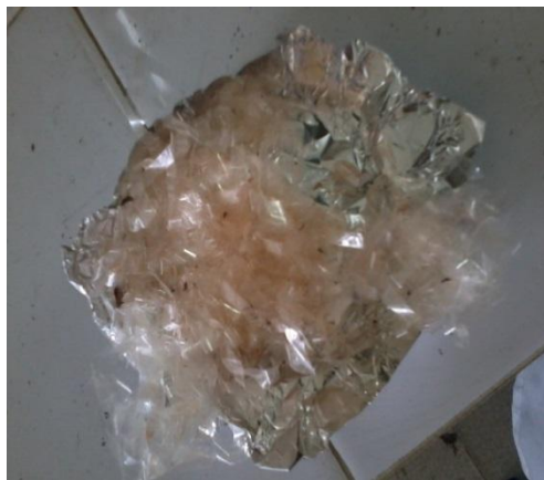
Hình 5. Dây băng đun với acetone trong 4 giờ
