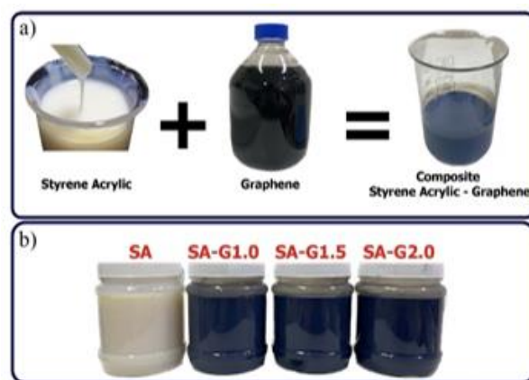
Hình 2 (a) Sơ đồ tổng hợp vật liệu composite SA-G. (b) Ảnh chụp hỗn hợp composite SA-G ở các tỉ lệ khối lượng hàm lượng rắn khác nhau
