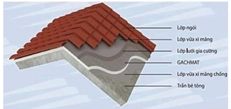
Hình 9 Gạch AAC cách âm, cách nhiệt, trích đoạn cấu tạo mái ngói dán sàn bê-tông cách nhiệt (gạch mát xốp PU)
