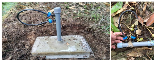
Hình 2 Bộ khuếch tán: (A) trước khi và (B) sau khi được chôn cách mặt đất 10 cm
