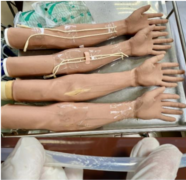
Hình 1 Tĩnh mạch trong mô hình tiêm truyền tĩnh mạch chi trên của Đức chế tạo. Mỗi mũi tiêm đều để lại vết kim, chỉ sau trung bình vài chục đến một trăm mũi tiêm là bị rỉ và xì nước
