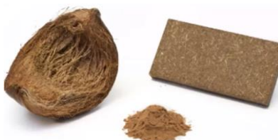
Hình 2 Tấm vách ngăn bằng gạo dừa vụn [4].
