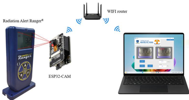
Hình 2 Minh họa cách kết nối và truyền thông tin giữa ESP32-CAM và phần mềm RadOCR Module này cho phép giao tiếp thông qua kết nối không dây wifi, bluetooth; hoặc kết nối nối tiếp (serial) qua
