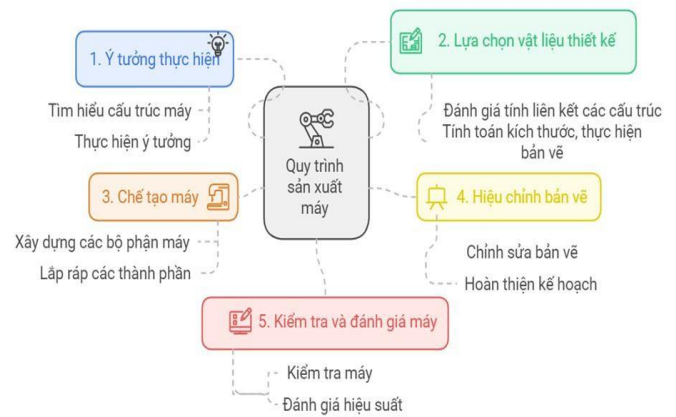
Hình 1. Sơ đồ quy trình chế tạo máy
