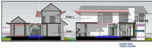
Hình 8 a. Hệ thống thông gió tự nhiên – “lối điều hòa” công trình b. Mặt cắt thể hiện mối quan hệ trong – ngoài thông qua hàng hiên
